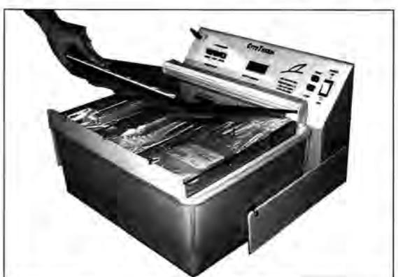
**Размораживатель для плазмы с тремя изолированными секциями и электронным устройством контроля температуры.**
