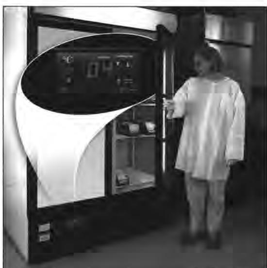
*Два стандартных электрических холодильника для крови, один из которых имеет стеклянные двери и электронный регистратор температуры.*
